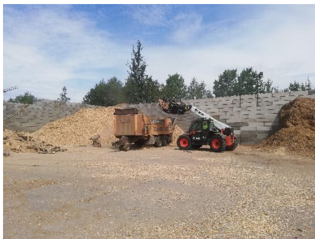
3.3.11 pav. Medinių pakuočių smulkinimo procesas greitaeigi smulkintuvu
