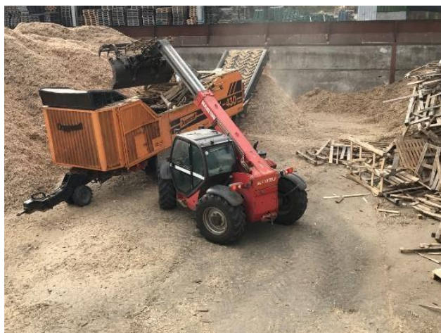
3.3.11 pav. Medinių pakuočių smulkinimo procesas greitaeigi smulkintuvu
