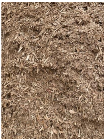
3.3.7 pav. Technologinė skiedra susmulkinta 60x60 mm sietu
