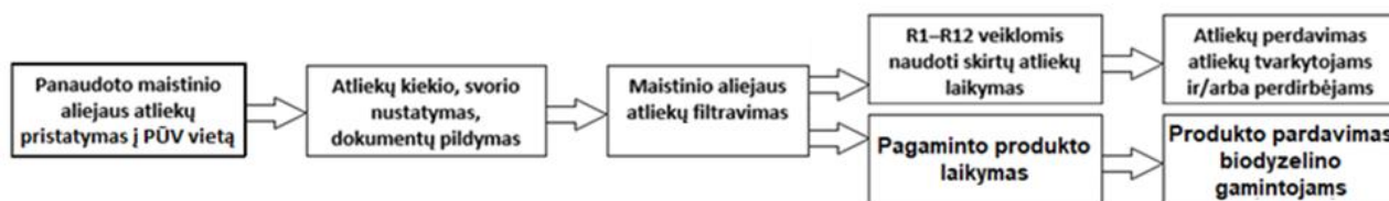
3. 6 pav. Panaudoto maistinio aliejaus (20 01 25) tvarkymo technologinio proceso schema
